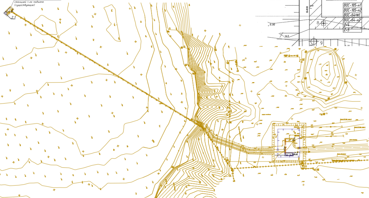
Водозаборные сооружения с насосной станцией 1-го подъема (существующие)
